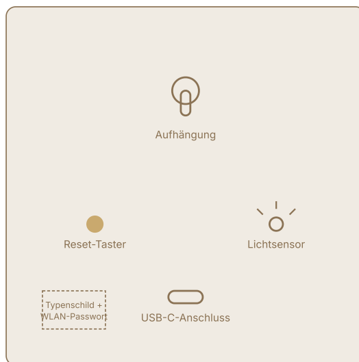
Rückseite: Aufhängung, Reset-Taster, Lichtsensor, USB-C, Typenschild
